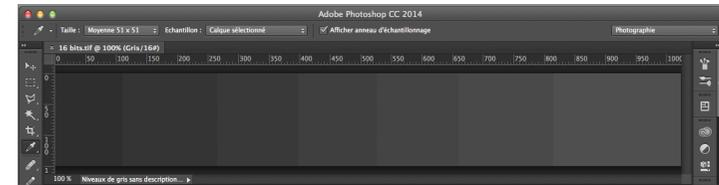
Ce dégradé est en 16 bit, suite à un réglage niveaux pour l'étirer du noir au blanc, le dégradé est lisse, et même repassé en 8 bit l'histogramme résultant ne présente aucune fracture
