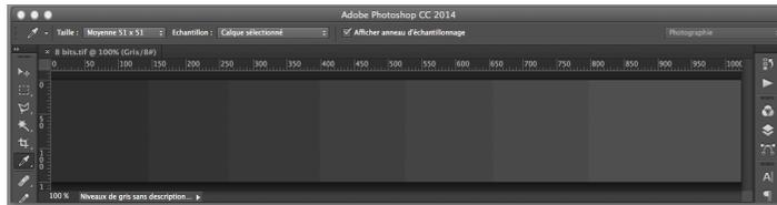
Ce dégradé est en 8 bit, suite à un réglage niveaux pour l'étirer du noir au blanc, il va présenter des bandes dues au manque de nuances dans la couche des gris, l'histogramme résultat est en forme de peigne.
